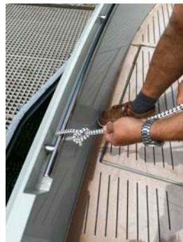
Der Anker wird an Backbord über die Bordwand gelassen, so, dass keine Fluken den Rumpf berühren. Erst wenn er unter dem Wasserspiegel ist, darf die Ankerleine auf die Ablassrolle gelegt werden und der Anker dann auf Grund gesetzt werden.
