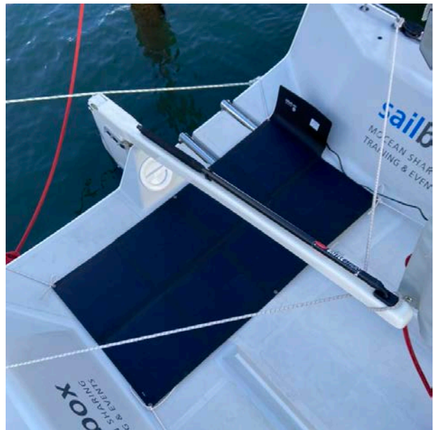
Solarpanel im Cockpit-Heck
