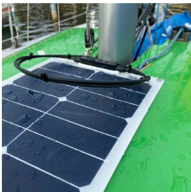
Panneau solaire sur le rouf (cap)
