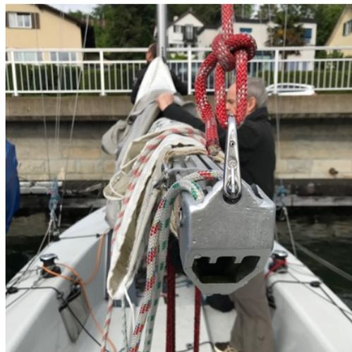
Tends l'écoute de grand-voile et fixe-la dans le taquet coinçant afin que la bôme ne puisse pas bouger. Il est important de sécuriser l'écoute de grand-voile avec un demi-tour autour du taquet coinçant afin qu'elle ne puisse pas se détacher.
