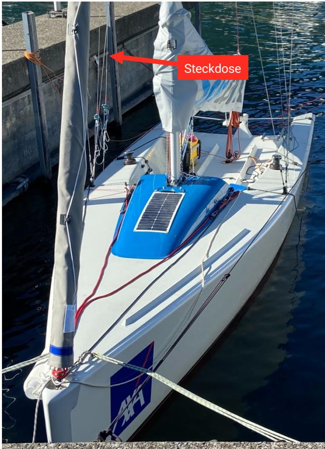
Das Stromkabel ist steuerbordseitig an der Mole eingesteckt. Achte darauf, dass das Kabel nie im Wasser liegt. Wickel es dazu einmal um den Grossschotblock bevor du es einsteckst.
