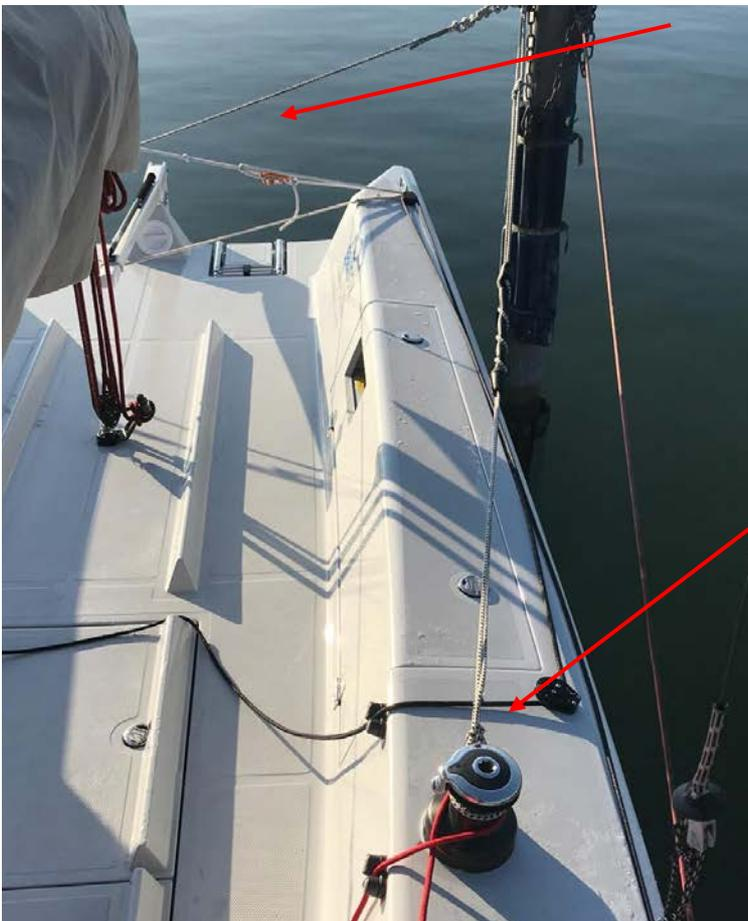
Die Heckleinen werden übers Kreuz geführt, durch die Bügel am Heck geschlauft und dann in den Karabiner eingehängt. Die Leinen führen **über** die Pinne.
