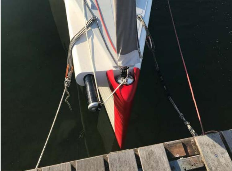
Die Schoten werden gerade kommend vom Steg durch das Padeye geschlauft und dann in den Karabiner eingehängt.
