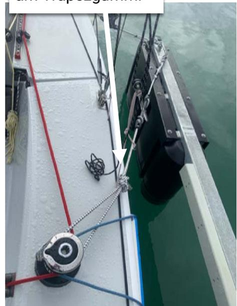
Die Achterspring muss zwischen den beiden Trapezgummis verlaufen, dass sie nicht scheuert (s. linkes Bild)
